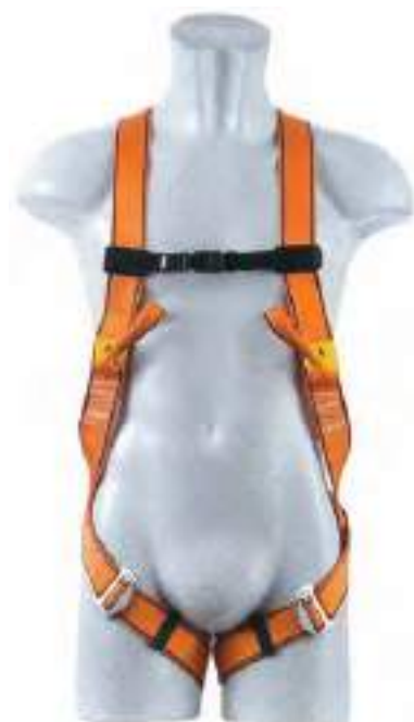
1141/33 IMBRAGATURA ANTICADUTA CON ATTACCO DORSALE+STERNALE Ancoraggio dorsale in acciaio con piastra di assorbimento Peso kg 0,69 2 fibbie di chiusura a regolazione rapida 2 attacchi sternali con asole in nastro
