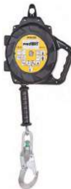
R10 DISPOSITIVO ANTICADUTA A FUNE Con riavvolgimento automatico Assorbitore di energia Omologato per utilizzo in verticale e orizzontale Funne metallica diametro 4 mm lunghezza 10 m
